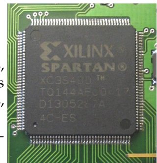
Un CPLD de Xilinx, contenant 400 000 opérateurs élémentaires.
